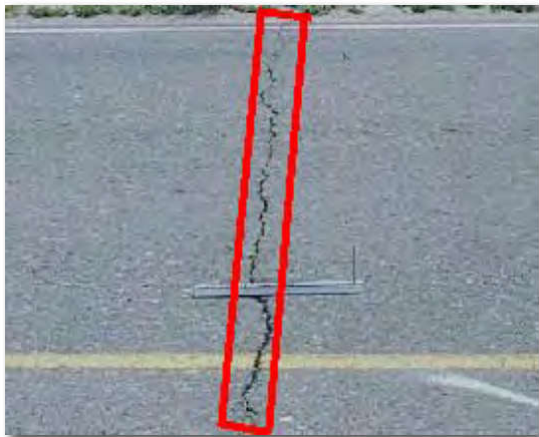
ภาพที่ 2. 8 ลักษณะและประเมินความเสียหายของความเสียหายประเภทรอยแตกตามแนวยาวและขวาง
